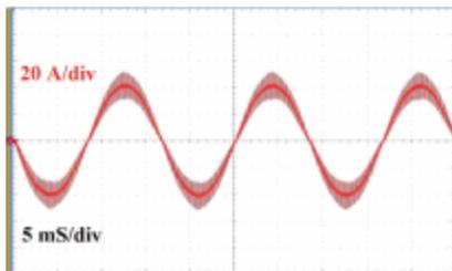
(d) Load current (Phase-A) with SFO-PWM POD (20A/div)
